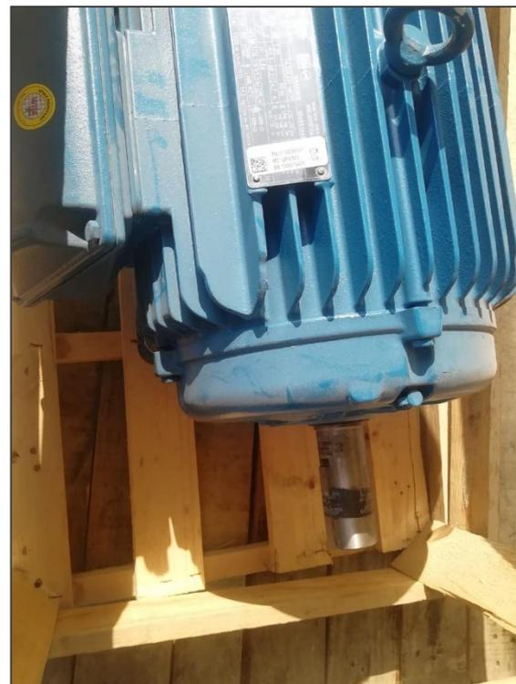
**Se hizo la requisición de un motor para sustitución del areador No 3 de la PTAR CS1, sin embargo al suministrar el motor llego incorrecto ya que el acoplamiento que surtieron para su instalación es para posición horizontal, mientras que el necesario es para instalación vertical. Se informó al proveedor y se llevaron el equipo para sustituirlo, estando pendiente su entrega.**
