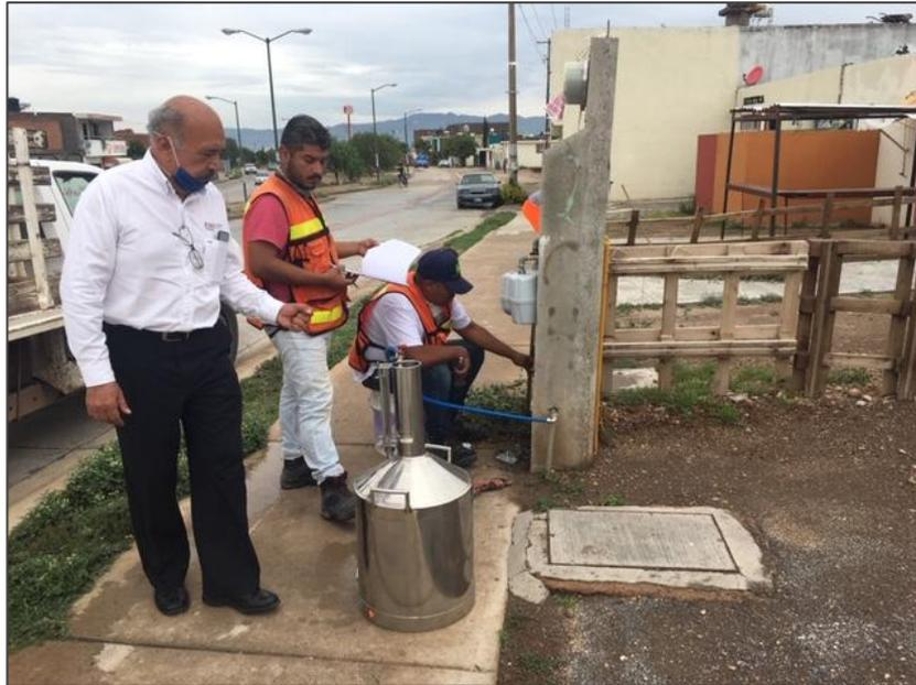
**Como parte de la atención de quejas, se hacen pruebas de verificación de funcionamiento de medidores domiciliarios con el medidor patrón de 50 lts con que contamos.**
